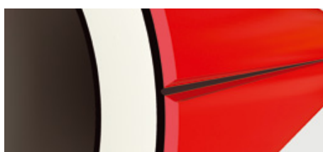
Рис. 11. Труба имеет незначительное повреждение, эксплуатация возможна
