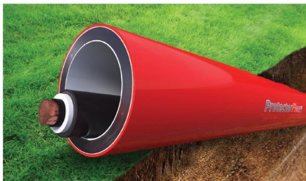
**5.4.1.** Полимерные трубы ПРОТЕКТОРФЛЕКС® ПРО - это многослойные негорючие термостойкие трубы из полимерного компаунда с дополнительным слоем красного цвета повышенной прочности для защиты трубы при протяжке методом горизонтально-направленного бурения.
