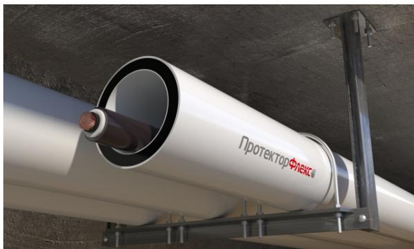
**5.3.1.** Полимерные трубы ПРОТЕКТОРФЛЕКС® НГ - это трехслойные негорючие термостойкие трубы из полимерного компаунда со специальным внутренним негорючим слоем и внешним негорючим слоем, обладающим повышенной стойкостью к воздействию ультрафиолета. Для уменьшения трения при тяжении кабеля в состав внутреннего слоя вводятся скользящие добавки.
