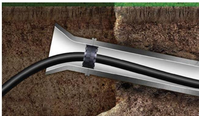
**7.1.1.** Уплотнитель высоковольтного кабеля серии ПРОТЕКТОРФЛЕКС® УВК предназначен для защиты трубы, в которой размещен кабель, от заполнения водой или грунтом, а также от заиливания. Применение уплотнителей УВК позволяет обеспечить возможность беспрепятственного ремонта или замены кабельной линии, проложенной в трубах.
