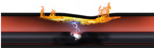
Рис. 4. Сравнение обычной полимерной трубы и термостойкой полимерной трубы с внутренним слоем ПВ-0
