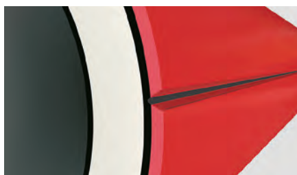
Рис. 13. Труба имеет незначительное повреждение, эксплуатация возможна
