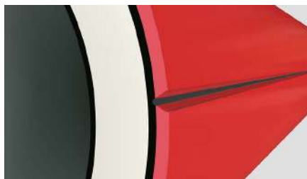
Рис. 13. Труба имеет незначительное повреждение, эксплуатация возможна
