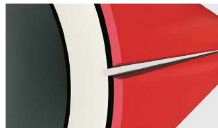
Рис. 14. Труба повреждена, эксплуатация ограничена
