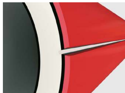
Рис. 9. Труба повреждена, эксплуатация ограничена
