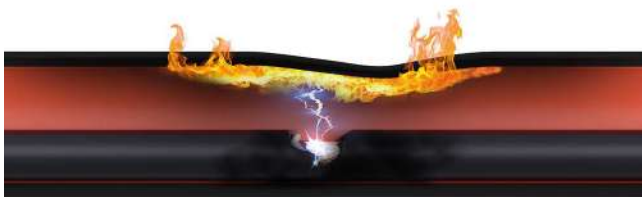
Рис. 4. Сравнение обычной полимерной трубы и термостойкой полимерной трубы с внутренним слоем ПВ-0
