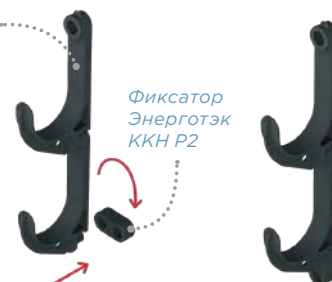
Рис. 53. Схема сборки крюков Энерготэк ККН
