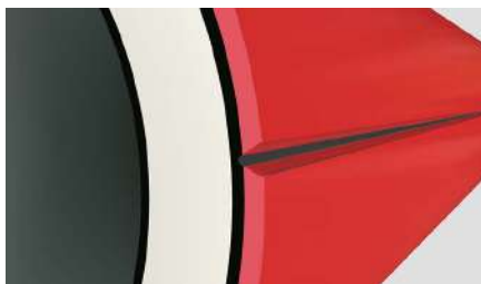
Рис. 13. Труба имеет незначительное повреждение, эксплуатация возможна
