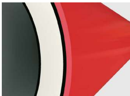
Рис. 7. Труба не повреждена, эксплуатация допустима
