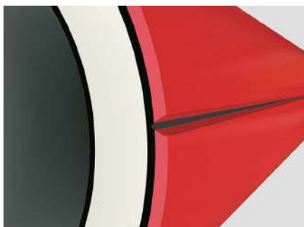
Рис. 8. Труба имеет незначительное повреждение, эксплуатация возможна
