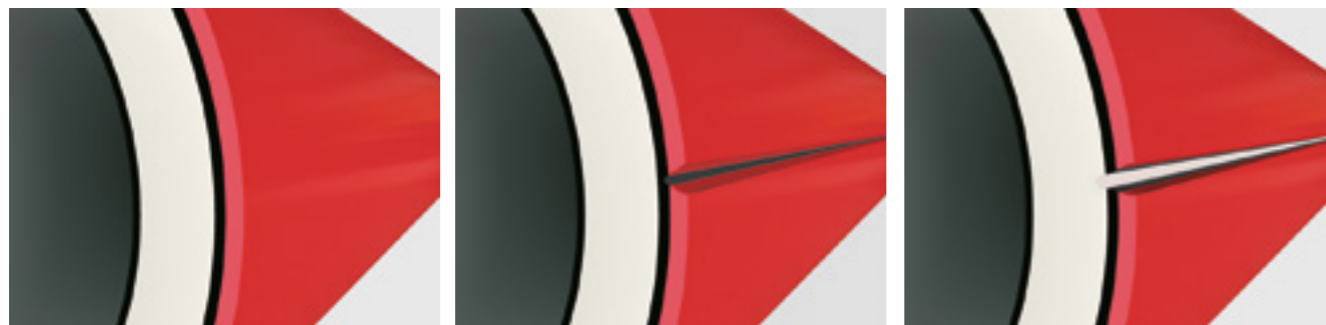
Рис. 5. Труба не повреждена, эксплуатация допустима
