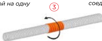
Рис. 44. Скручивание муфты с одной трубы и одновременное навинчивание на другую таким образом, чтобы на каждую трубу приходилась половина муфты
