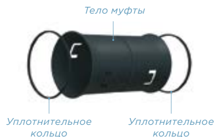
Рис. 56. Конструкция муфты «труба – труба»
