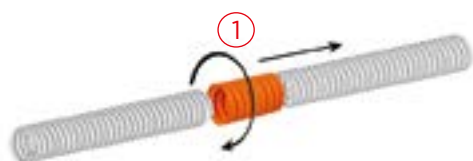
Рис. 42. Навинчивание муфты ПротекторЛайн® МК всей длиной на одну из соединяемых труб
