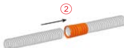
Рис. 43. Совмещение торцов соединяемых труб друг с другом
